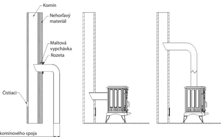
Samostatné krbové kachle by sa mal umiestniť na nehorľavý podstavec s dostatočnou nosnosťou. Ak podklad nemá na hmotnosť krbových kachlí vhodnú nosnosť treba na zlepšenie nosnosti podkladu urobiť príslušné opatrenia (napr. použitie platní, ktoré zaťaženie rozložia na rozľahlejšiu plochu). Samostatné krbové kachle by sa mal pripojiť k samostatnému komínu (na odvod spalín).
