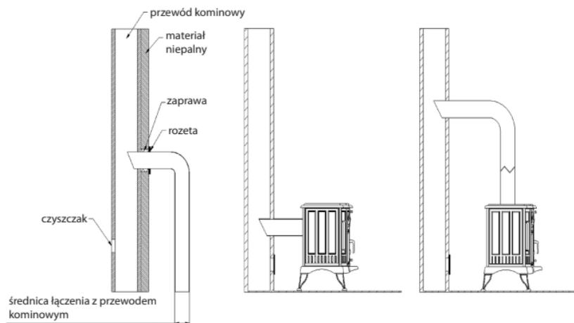
Piec wolnostojący powinien być ustawiony na niepalnym podłożu o odpowiedniej nośności.
