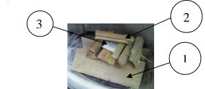
Nach ca. 5 - 10 Minuten (Holzscheite gut angebrannt) Verbrennungsluftklappe um ca. 50 % schließen (Regler auf Mittelstellung bringen)
