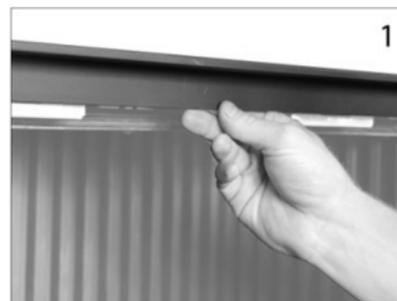
**2. Schritt:** Entriegeln Sie die jetzt sichtbar gewordenen Handgriffe (bei den Eckmodellen und dreiseitigen Feuerstellen befinden sich diese Handgriffe unter dem Mantel), indem Sie sie leicht nach oben und in Ihre Richtung ziehen.
