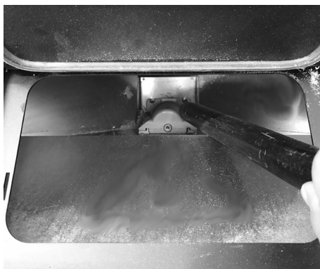
Fig. 33 - Czyszczenie zbiornika i ślimaka
