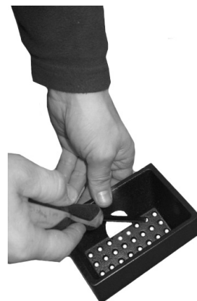
Fig. 24 - Czyszczenie rusztu paleniskowego
