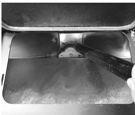
Fig. 23 - Czyszczenie zbiornika i ślimaka
