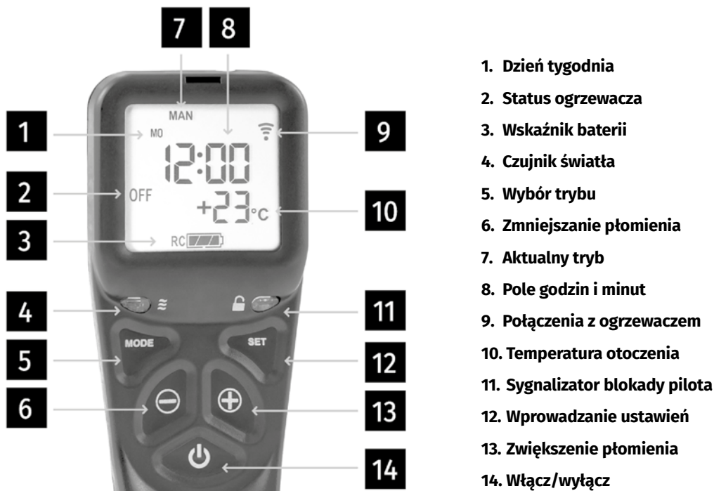
Rys. 7. Pilot zdalnego sterowania typu FB 868D (TESC)
