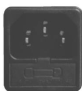
Rys. 43 - Gniazdo elektryczne z wyłącznikiem głównym
