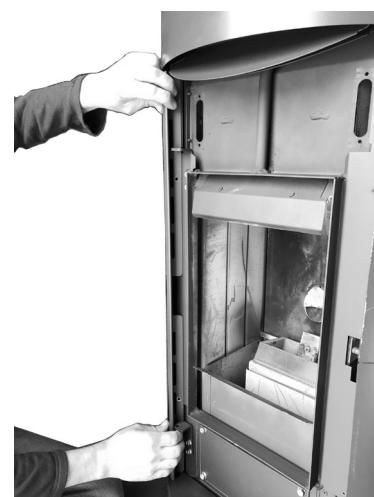
Fig. 65 - Usuwanie profili przednich (prawy i lewy).
