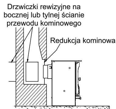
Rys.7. Podłączenie pieca do przewodu kominowego z wykorzystaniem wylotu spalin na tylnej ścianie urządzenia
