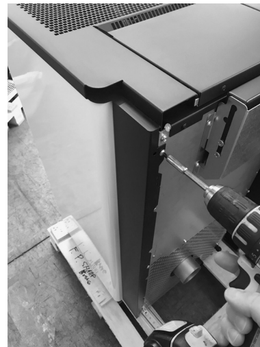
Fig. 36 - Przymocować kompletną boczną ściankę
