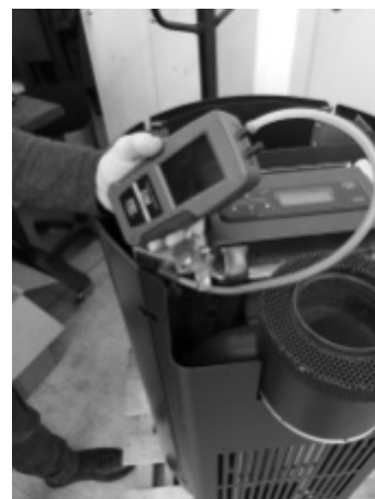
Fig. 62 - Połączenie presostatu cyfrowego
