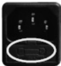
Fig. 74 - Drzwiczki z bezpiecznikami do wyjęcia
