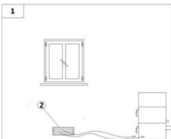
Fig. 7 - Dopływ bezpośredniego powietrza
