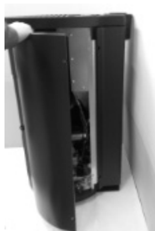
Fig. 44 - Odcepić boczne ścianki
