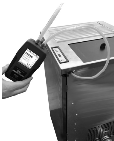
Fig. 61 - Połączenie presostatu cyfrowego
