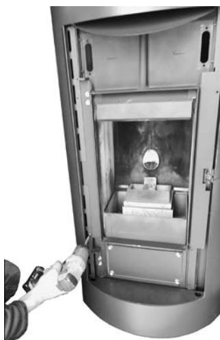
Fig. 22 - Usuwanie drzwi profili (prawy i lewy).
