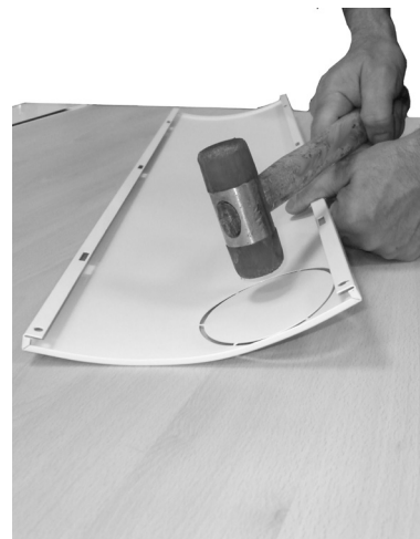
Fig. 38 - Otwarcie otworu (model Sfera 3 Plus)
