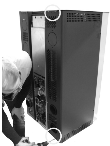
Fig. 94 - Usuwanie śrub tylnych
