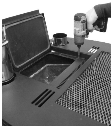
Fig. 41 - Usuwanie śrub górnych
