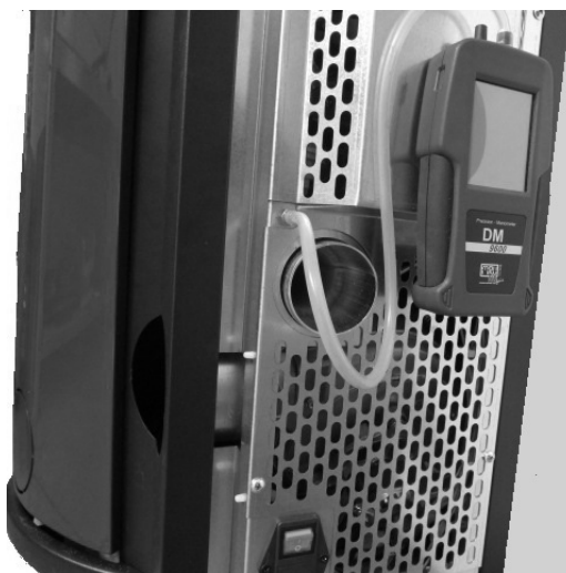
Fig. 55 - Podłączenie presostatu cyfrowego
