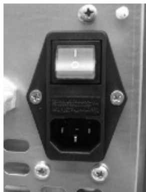
Fig. 54 - Gniazdko prądu z wyłącznikiem głównym
