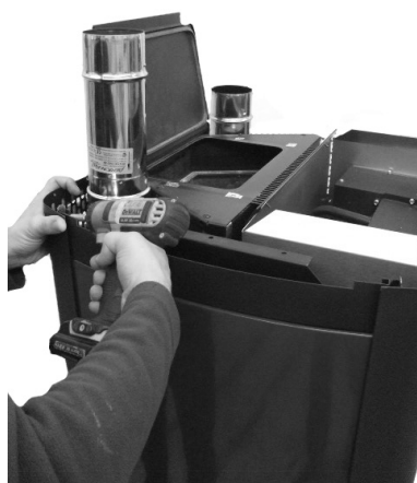
Fig. 91 - Usuwanie górnych zakrzywionych profili
