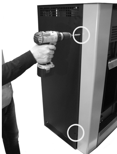
Fig. 93 - Usuwanie śrub bocznych
