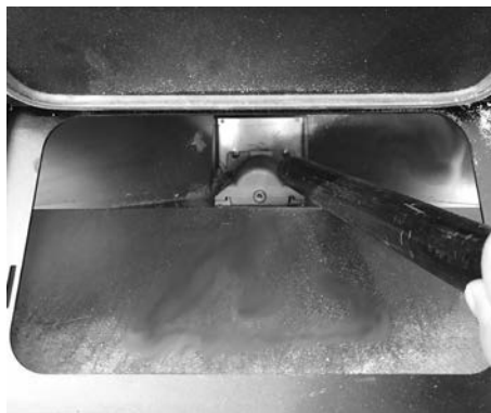
Fig. 25 - Czyszczenie zbiornika i ślimaka
