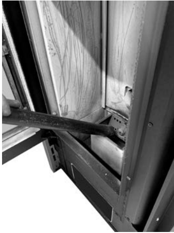
Fig. 23 - Czyszczenie miejsca na ruszt paleniskowy
