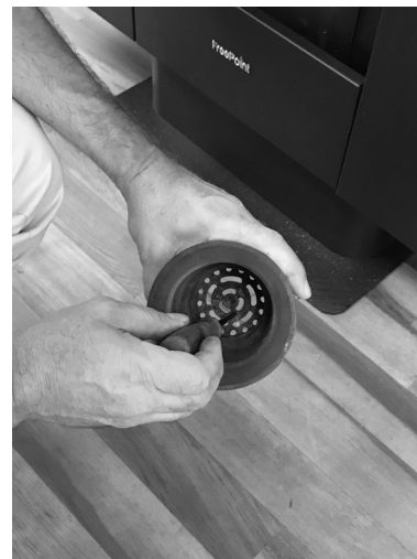
Fig. 25 - Czyszczenie rusztu paleniskowego
