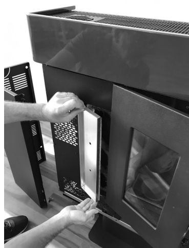
Fig. 31 - Zdejmowanie panelu rewizyjnego
