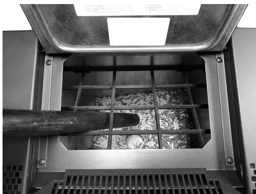
Fig. 29 - Czyszczenie zbiornika i ślimaka
