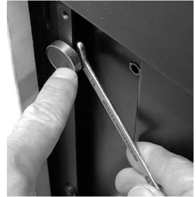
Fig. 30 - Dopasowywanie magnesu i zablokowanie kluczem
