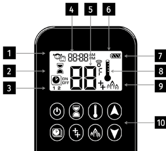
Rys. 10. Pilot zdalnego sterowania typu SYMAX (MAXITROL): 1 - Child Proof, 2 - Tryb Wyłącznik czasowy, 3 - Tryb Programowany, 4 - Pole godzin i minut, 5 - Temperatura otoczenia, 6 - Wyświetlacz, 7 - Wskaźnik baterii, 8 - Tryb Termostat, 9 - Tryb ECO, 10 - Przyciski
