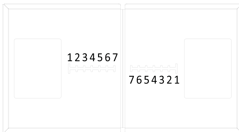
Rys. 6. Oznaczenie pozycji uchwyty przestony w zespole deflektorów (1 - całkowicie zamknięta, 7 - całkowicie otwarta)
