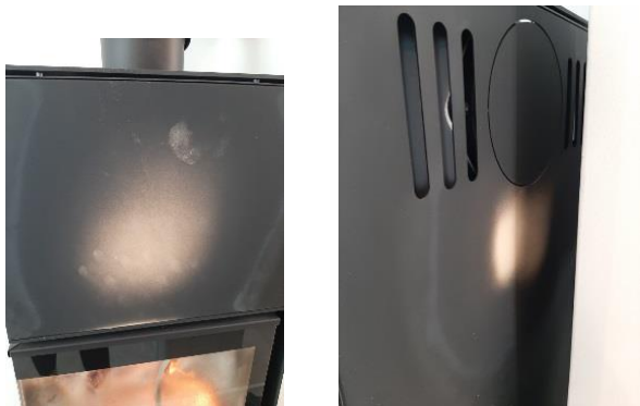
Rysunek 10. Przykłady przebarwień powstałych w wyniku przegrzewania urządzenia.
