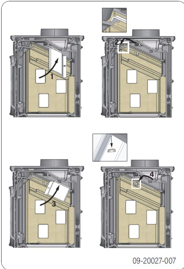
Reihenfolge zum Einbringen der Edelstahl-Flammplatten:
