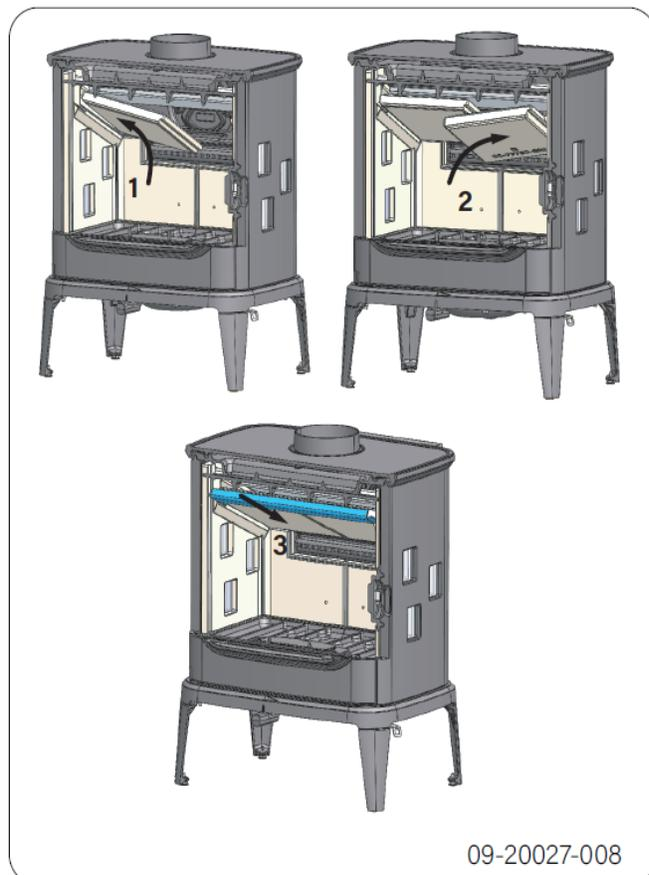
Rekkefølge for innsetting av vermiculitt-ledeplate:
