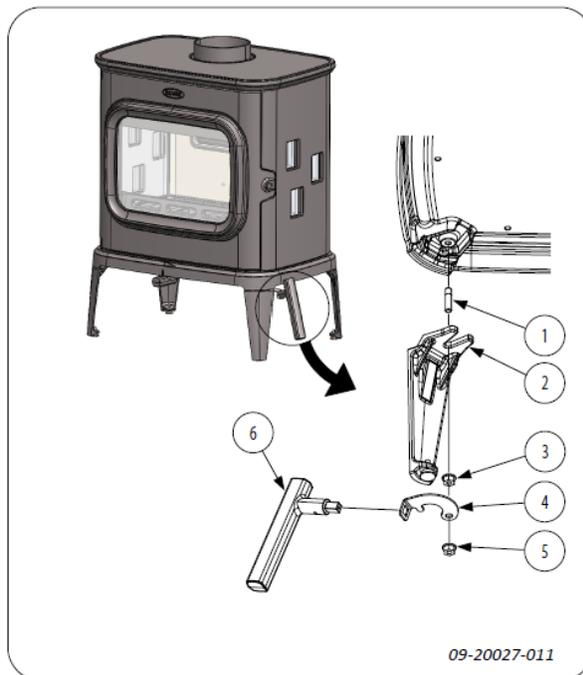
La stufa è dotata di un supporto per la leva (4) che può essere fissato sotto una delle gambe anteriori mediante un dado esagonale in dotazione (5).
