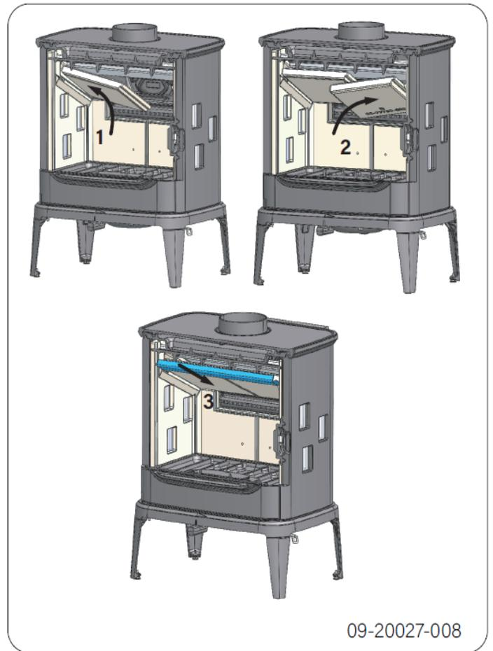
Ordine da seguire per l'inserimento delle piastre fiamma in vermiculite:
