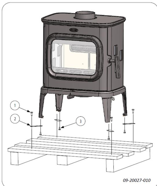
1. Retirez l'appareil de la palette en ôtant les boulons (1).
