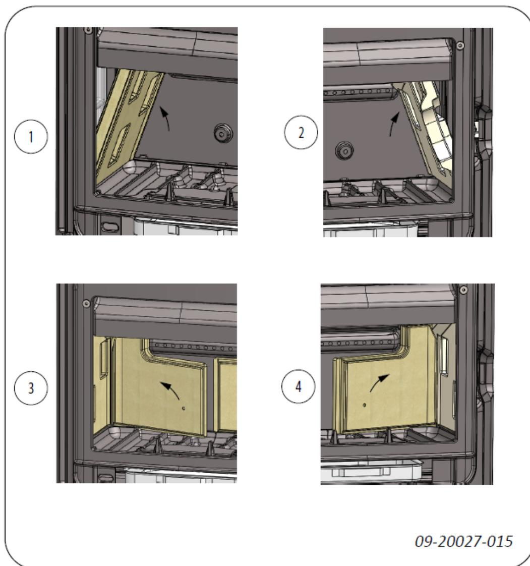
Rekkefølge for innsetting av vermiculitt indre plater:
