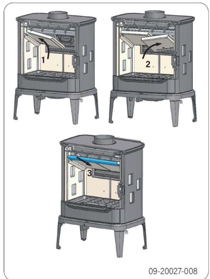
Reihenfolge zum Einbringen der Vermiculit-Flammplatte:
