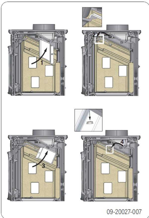
Rekkefølgen på innsetting av ledeplater i rustfritt stål:
