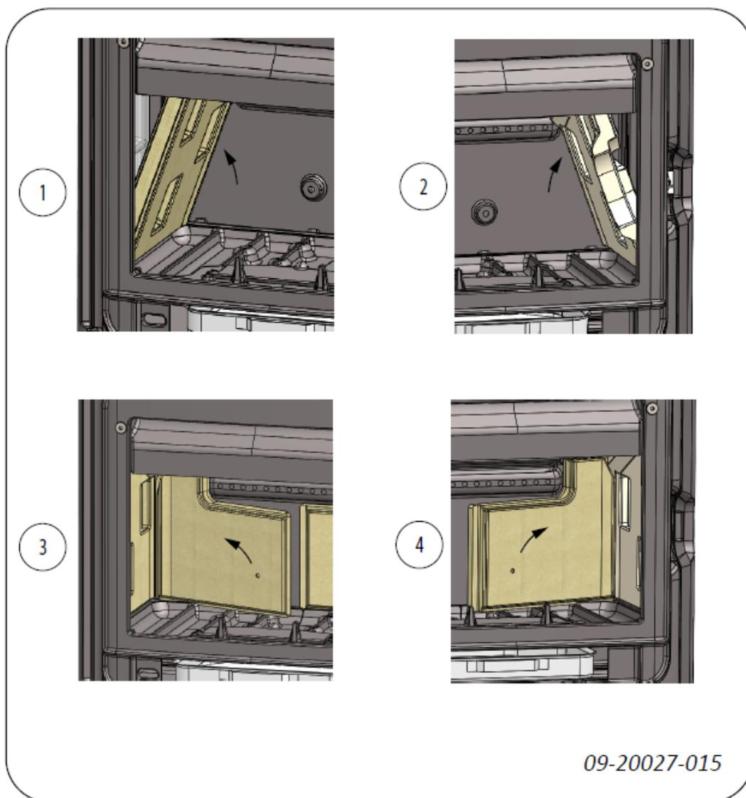
Orden de colocación de las placas internas de vermiculita:
