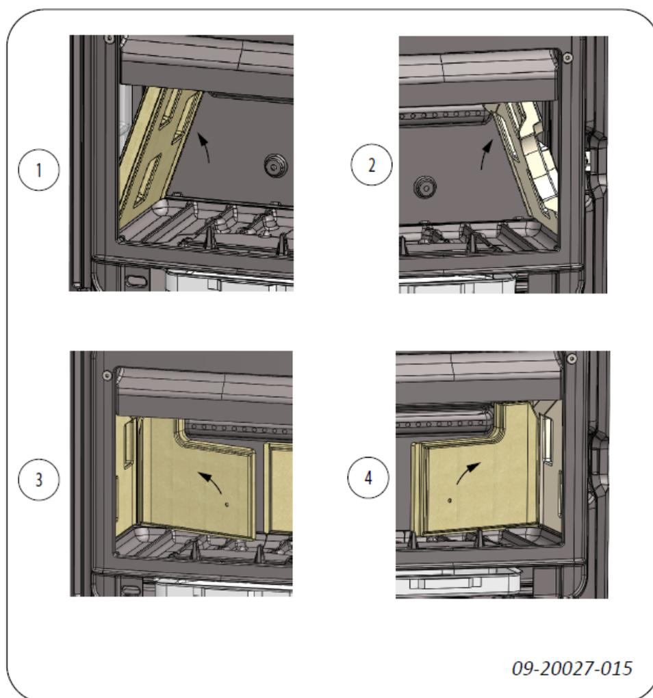
Ordre d'insertion des plaques intérieures en vermiculite :
