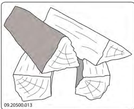
Bei einer losen Stapelung verbrennt das Holz schnell, da der Sauerstoff jedes Holzstück einfach erreichen kann. Stapeln Sie das Holz lose, wenn Sie kurz heizen möchten.
