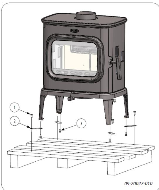
1. Nehmen Sie das Gerät von der Palette ab, indem Sie die Schrauben (1) entfernen.
