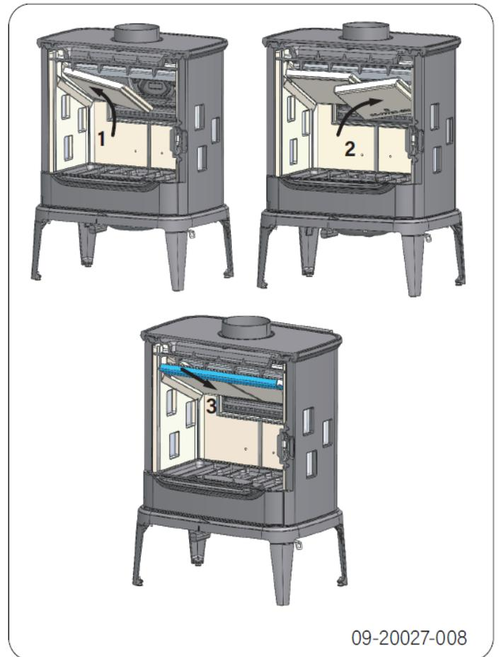
Volgorde inbrengen van de vermiculieten vlamplaat:
