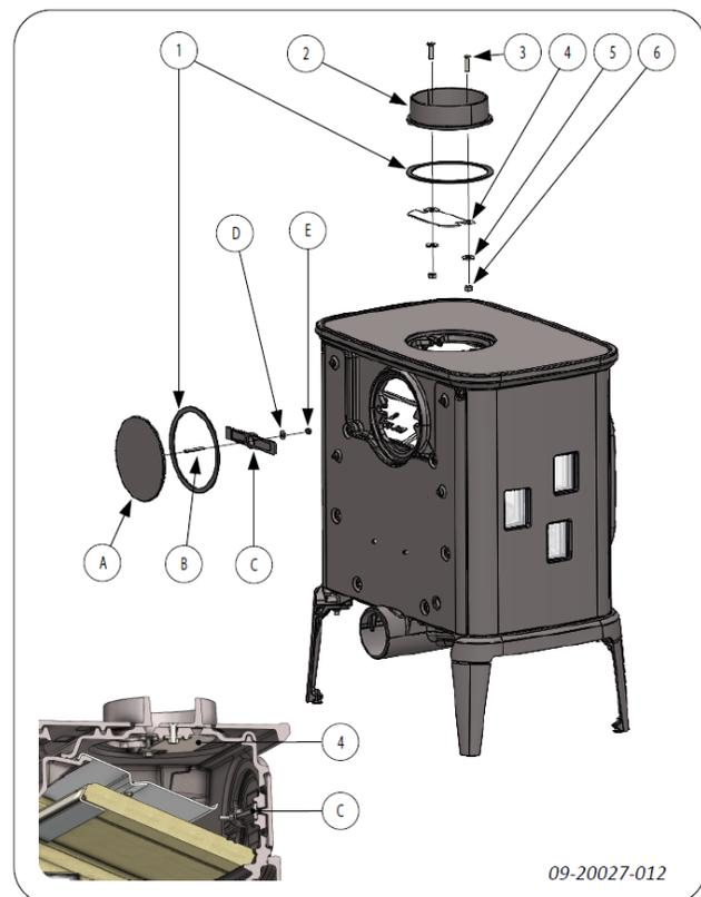
1. Retirez le collier de raccordement (2) et l'obturateur (4) du dessus de l'appareil.
