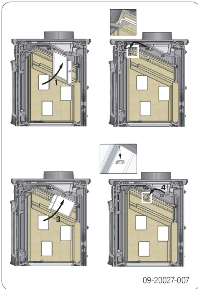
Volgorde inbrengen van de RVS-vlamplaten:
