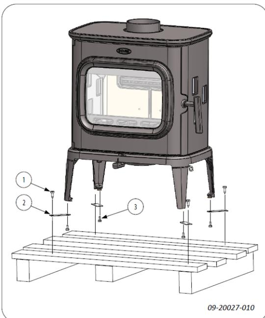
1. Retire el aparato del palet desatornillando los tornillos (1).
