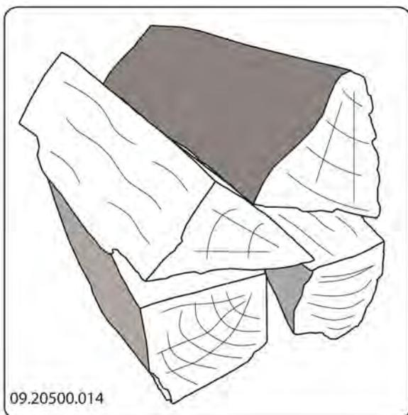
Ved kompakt ilegg forbrenner veden saktere fordi det kommer oksygen til bare noen av vedskiene. Bruk kompakt ilegg hvis du skal fyre lengre.
