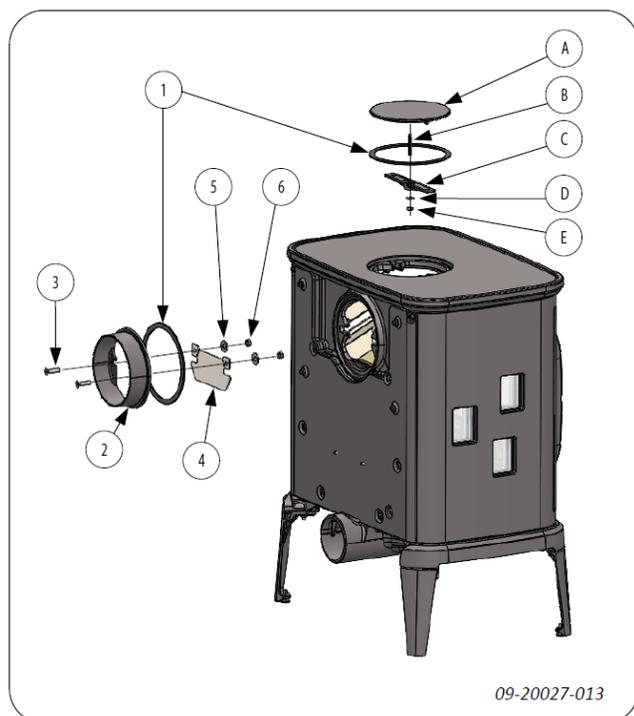
3. Montare il manicotto (2) e la piastrina di bloccaggio (4) utilizzando i materiali di fissaggio (3, 5, 6) sul pannello posteriore.
