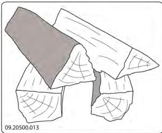
Apilando los leños de manera suelta, la leña se quema mucho más rápido, ya que el oxígeno puede llegar a todas las partes de la madera. Utilice un apilamiento suelto si quiere que el fuego prenda rápidamente.
