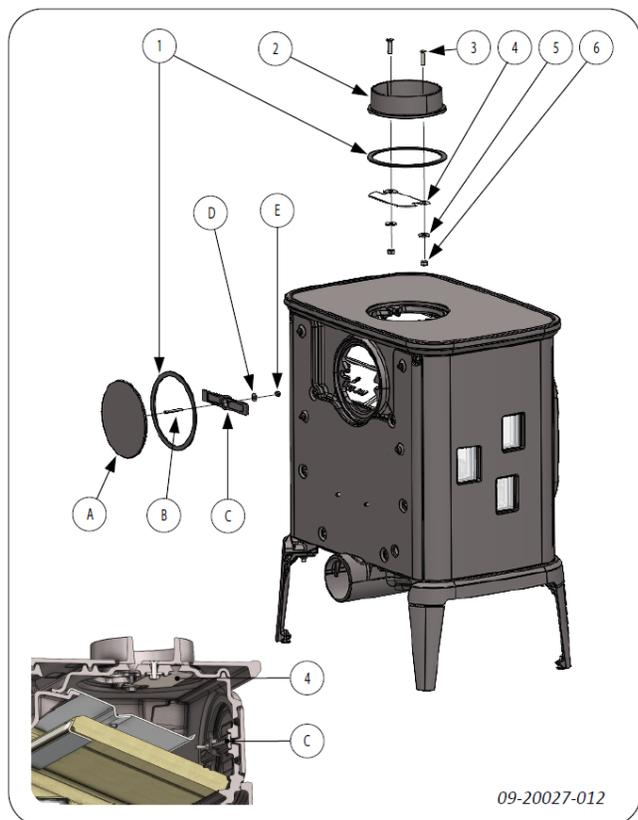
1. Entfernen Sie das Anschlussstück (2) und den Bremsklotz (4) von der Oberseite des Geräts.
