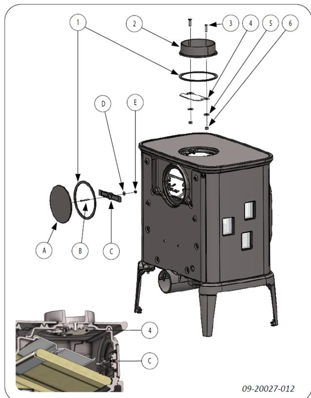
1. Retire el cuello de conexión (2) y la placa de freno (4) de la parte superior del aparato.
