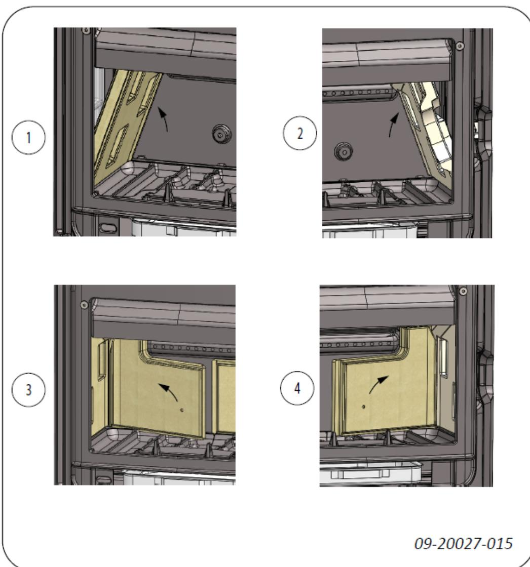
Volgorde inbrengen van de vermiculieten binnenplaten:
