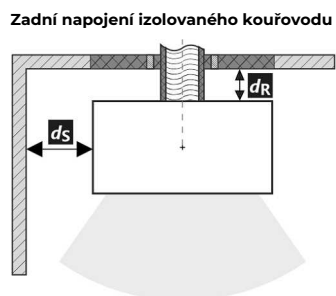
Zadní napojení izolovaného kouřovodu
