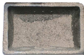
Rys. 36 - Przykład brudnego paleniska
