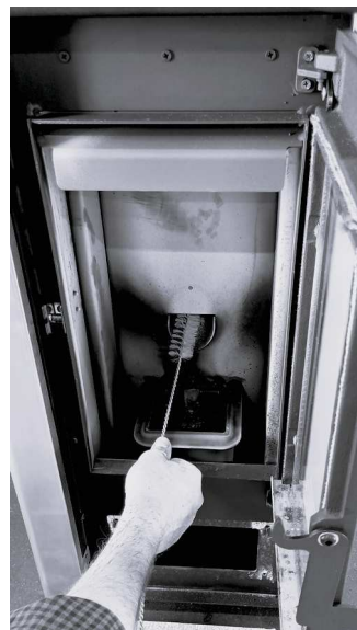
Rys. 40 - Czyszczenie za pomocą szczotki
