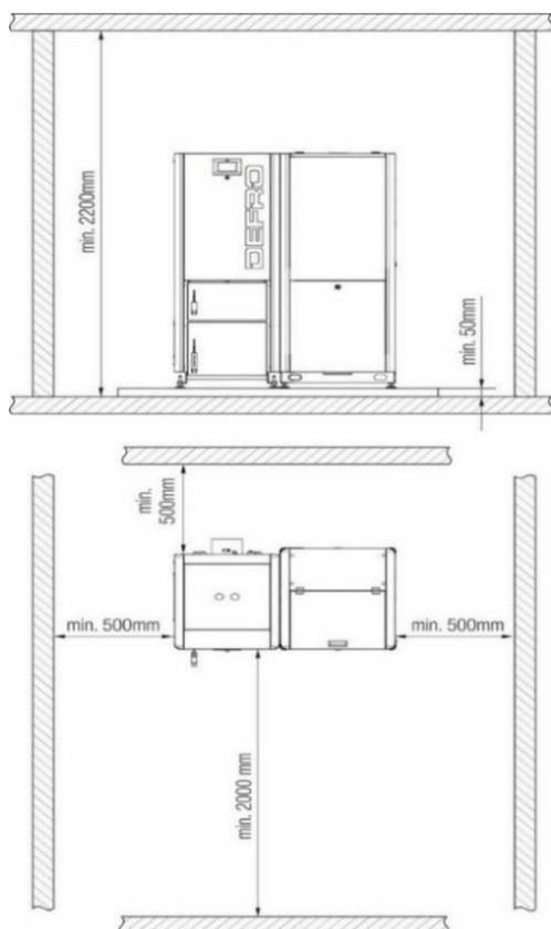
Rysunek 6. Ustawienie kotła w pomieszczeniu kottowni.
