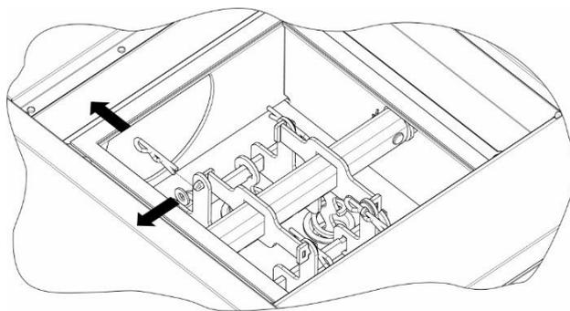
KROK 3. Rozłączyć ramię mechanizmu systemu automatycznego czyszczenia poprzez wypięcie zawleczeni
