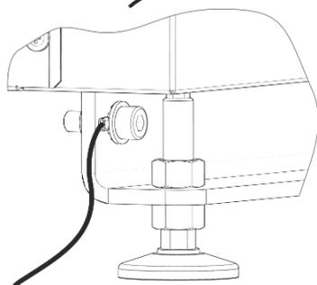
Rysunek 12. Uziemienie kotła.
