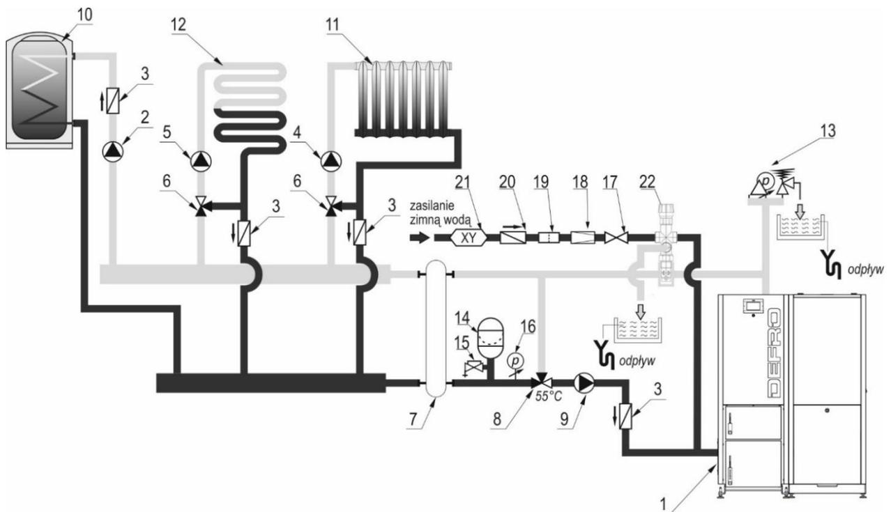
Rysunek 11 Uproszczony schemat instalacji grzewczej systemu zamkniętego.
