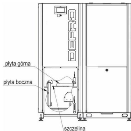
Rysunek 2. Rozmieszczenie katalizatorów ceramicznych w kotle, wersja ze zbiornikiem z prawej strony
