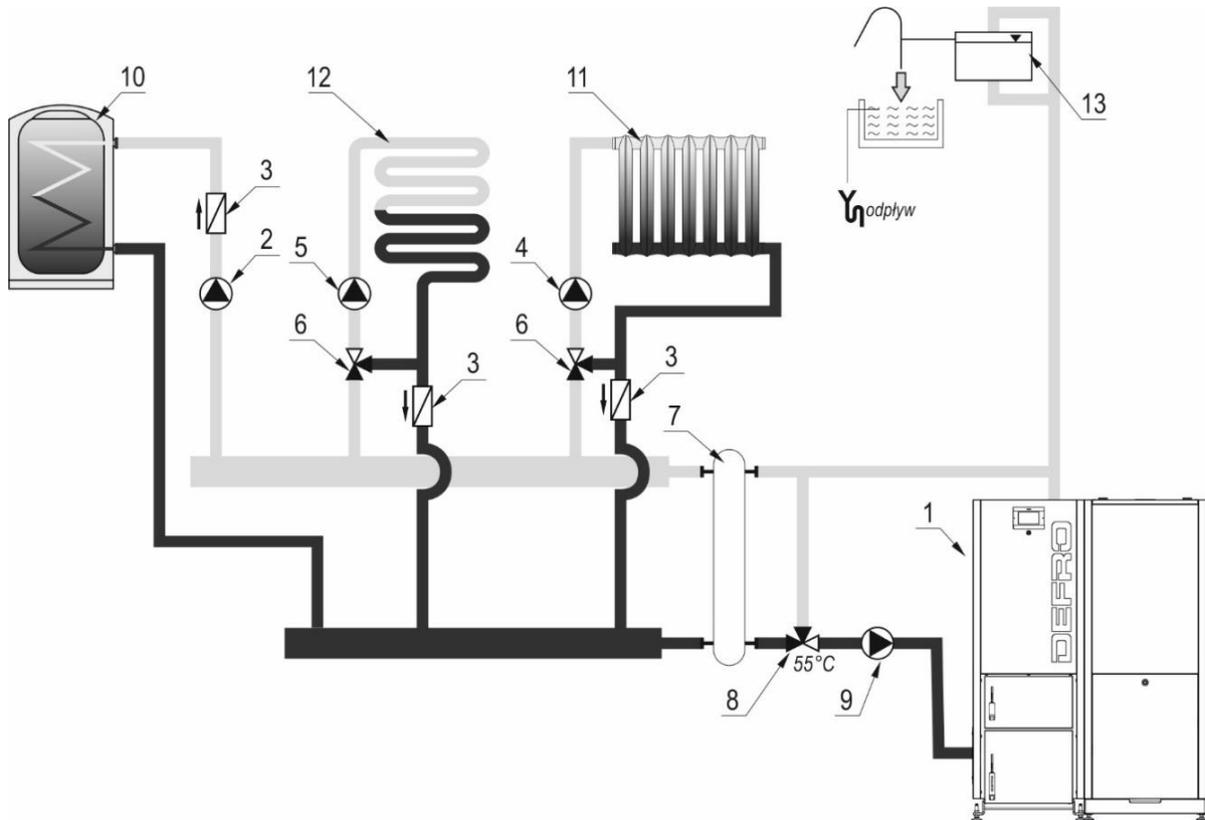
Rysunek 10. Uproszczony schemat instalacji grzewczej systemu otwartego.
