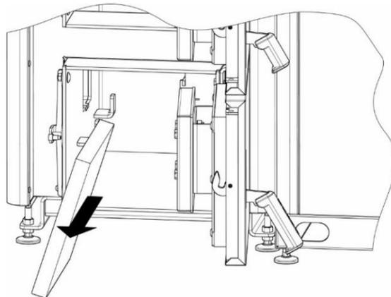
KROK 5: Wysunąć płytę ceramiczną z kotła. Oczyszczyć ściany komory paleniskowej kotła. Ponownie umieścić płyty ceramiczne w kotle postępując w odwrotnej kolejności.
