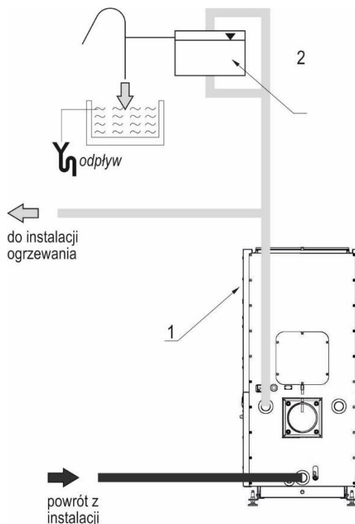
Rysunek 5. Przykładowy schemat zabezpieczeń kotła CALORI w układzie otwartym 1-kocioł; 2-otwarte naczynie wzbiorcze.
