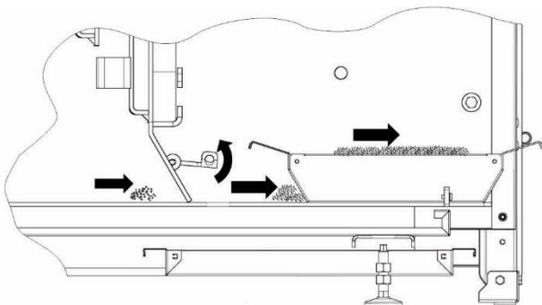
Rysunek 12. Sposób usuwania popiołu z kotła.
