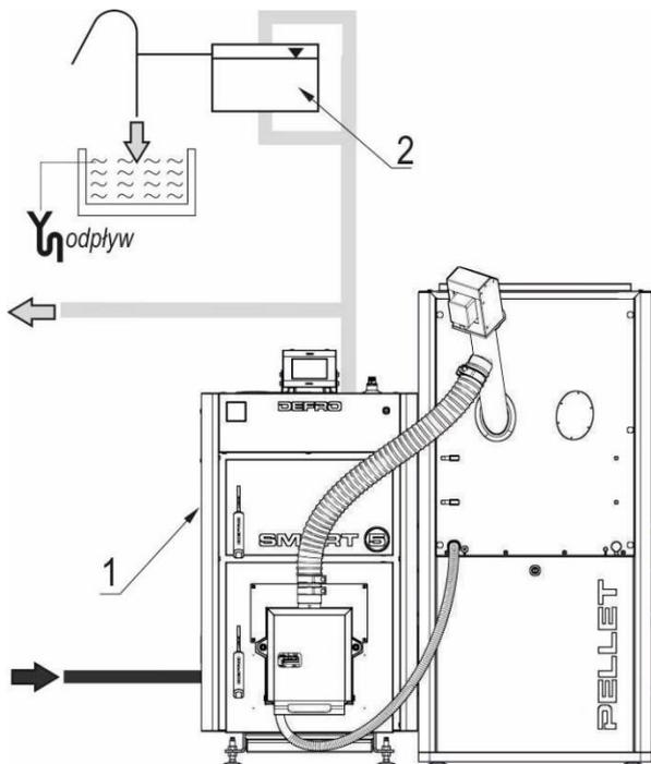
Rysunek 6. Przykładowy schemat zabezpieczeń kotła w układzie otwartym:
