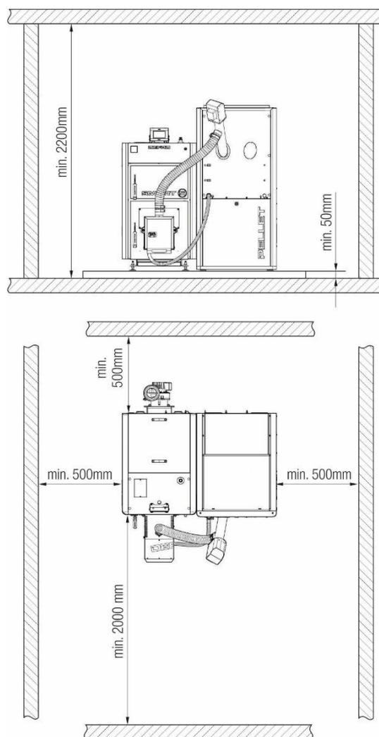
Rysunek 4. Ustawienie kotła w pomieszczeniu kotłowni.
