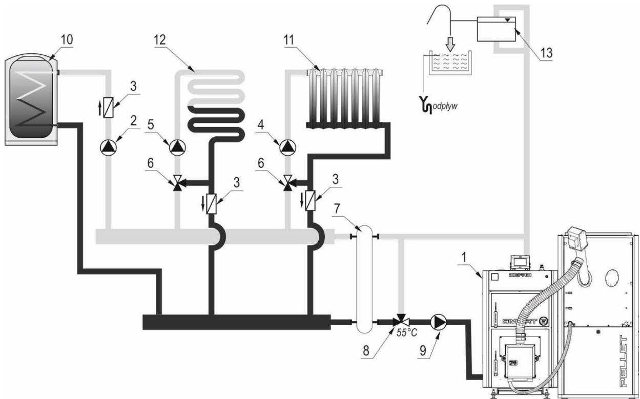
Rysunek 10. Uproszczony schemat instalacji grzewczej systemu otwartego.
