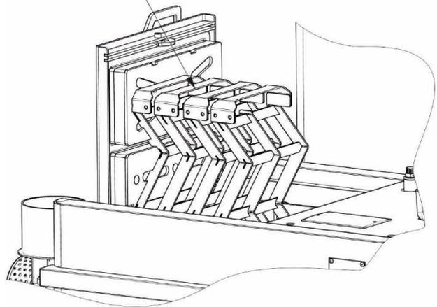
Rysunek 13. Zawirowywacze w kotle.
