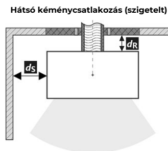
A füstcső áthaladása éghető anyagból készült falon
