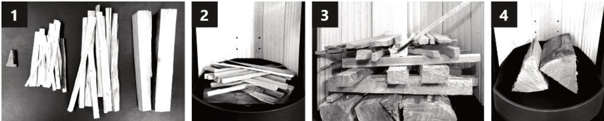
Kép 4. A fa előkészítési eljárása az égetőkamrában
