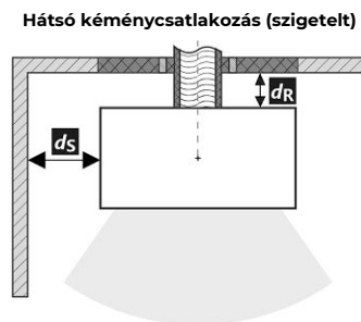
A füstcső áthaladása éghető anyagból készült falon
